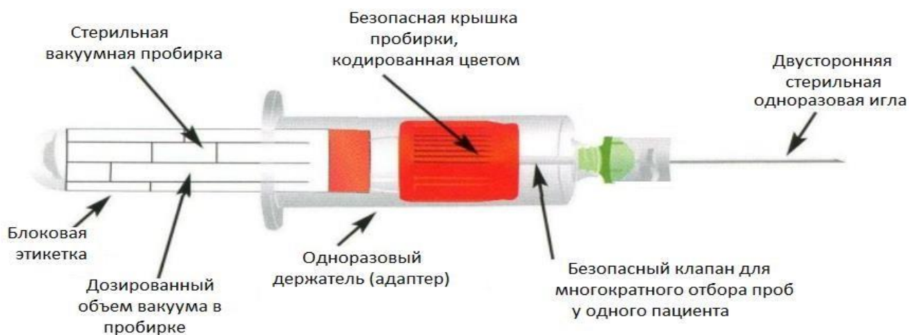
Рисунок 1 - Вакуумная система для взятия крови
